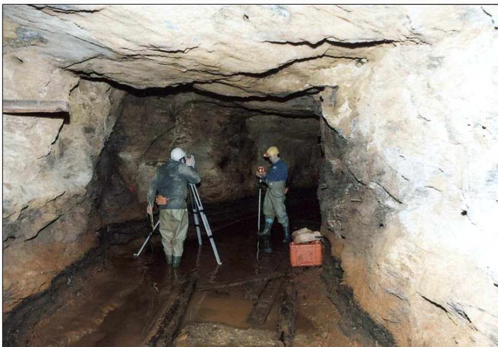
Abb.4 : Vermessungsarbeiten im Querschlag 1 zur Vervollständigung der markscheiderischen Rissunterlagen im Bearbeitungsbereich
