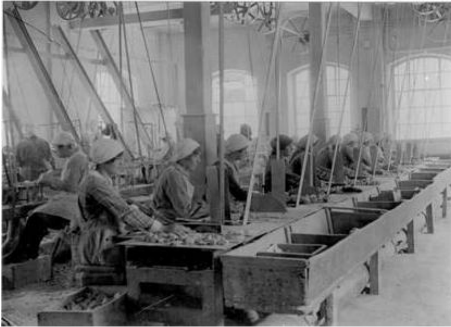
Abbildung 3: Steinsägen zur Erzeugung von Rohlingen für Gasbrenner
