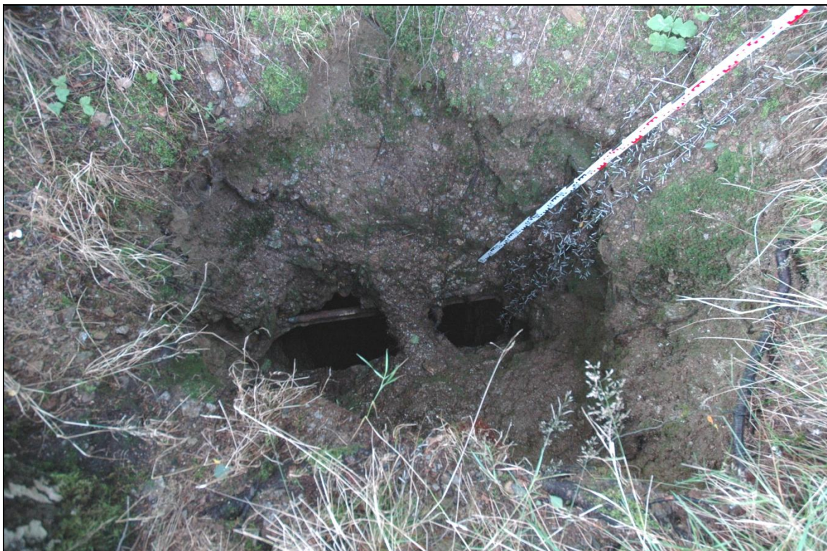
Bild 3: Teilverbrochene Abbühnung aus Schienen und Holz im Tagesüberhauen „Gesenk 20“, Abbaufeld Schacht 137
