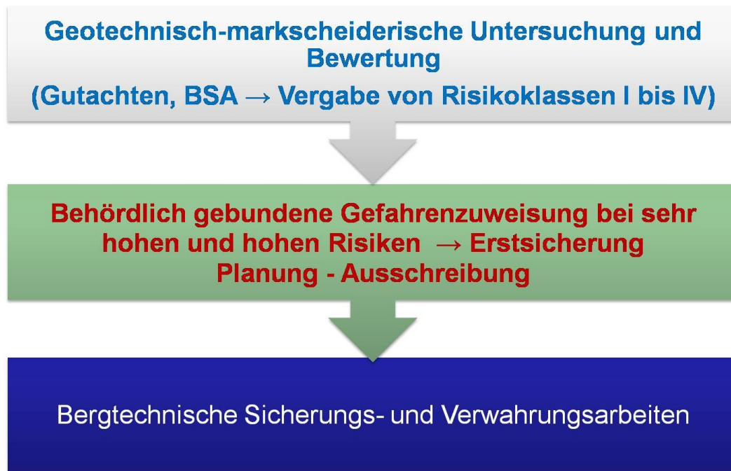
Abb.3 : Fließschema von der Risiko- und Gefahrenzuweisung bis zu bergtechnischen Sicherungs- und Verwahrungsarbeiten
