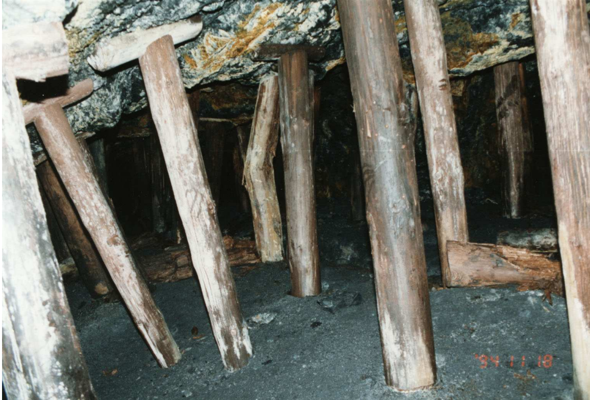
Abb.3 : Holzausbau Ende des 18. Jahrhunderts in einem Alaunschiefer-Bergwerk im Thüringer Schiefergebirge.
