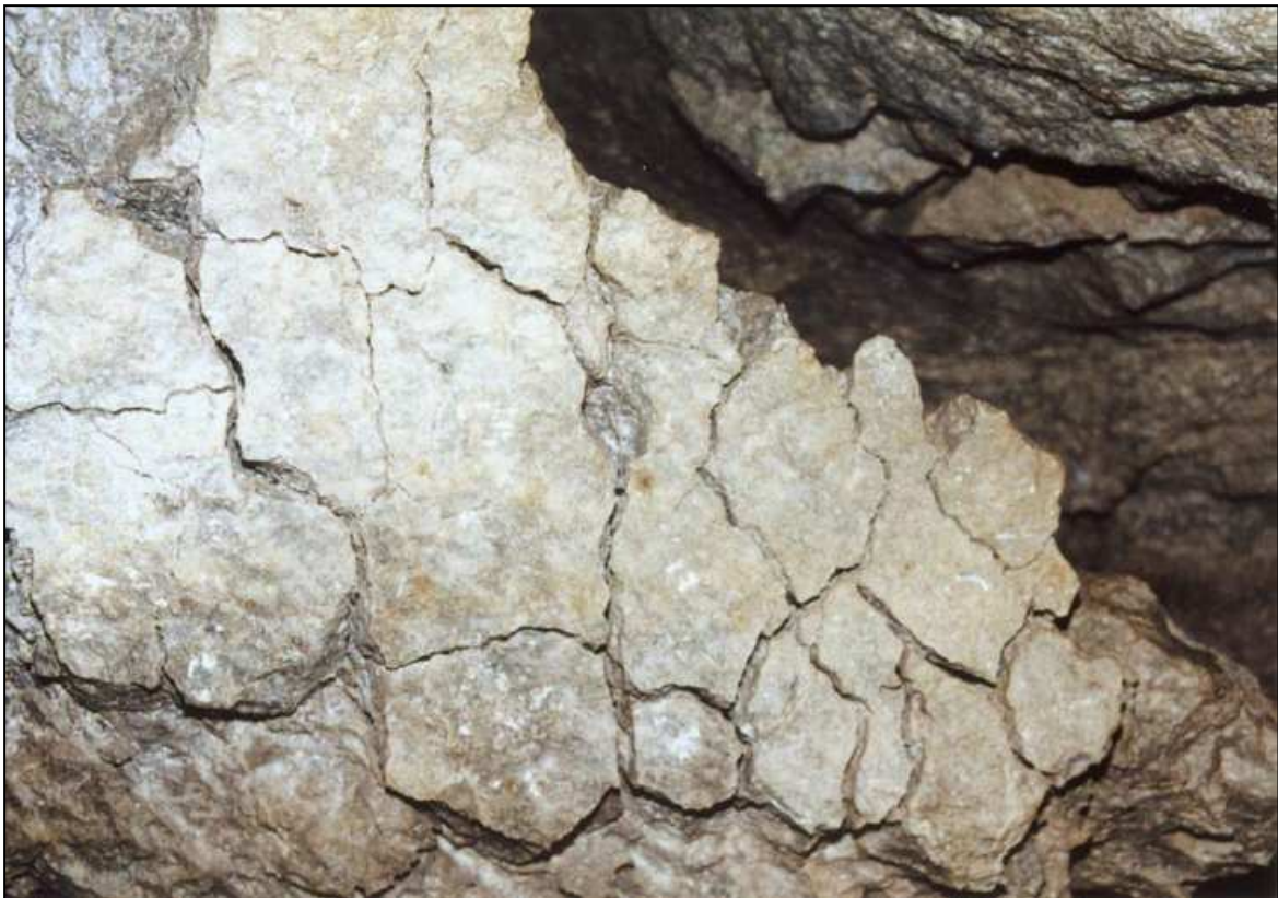
Fig. 9: Das kompakte Gestein löst sich durch die Vergipsung auf
