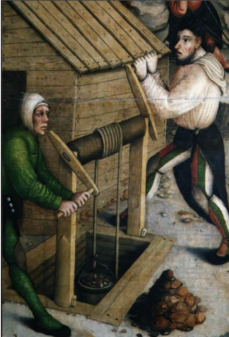
Bild 8: Mit Hilfe einer zweimännischen Haspel wird aus dem Schacht Erz gefördert
